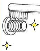
ディスクホイール取付面、ホイールナット当たり面、ハブ取付面(ISO方式では、ハブのはめ合い部も)、ホイールボルト、ナットの錆やゴミ、泥、追加塗装などを取り除きます。
